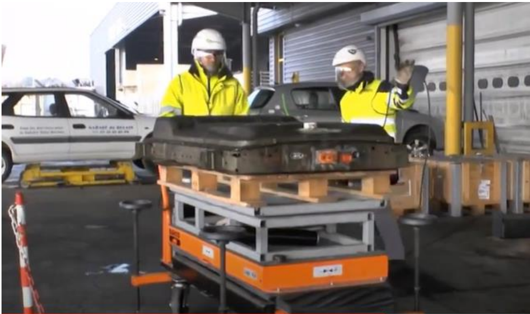
Mise en sécurité de la batterie d'un VE après décharge (5)
