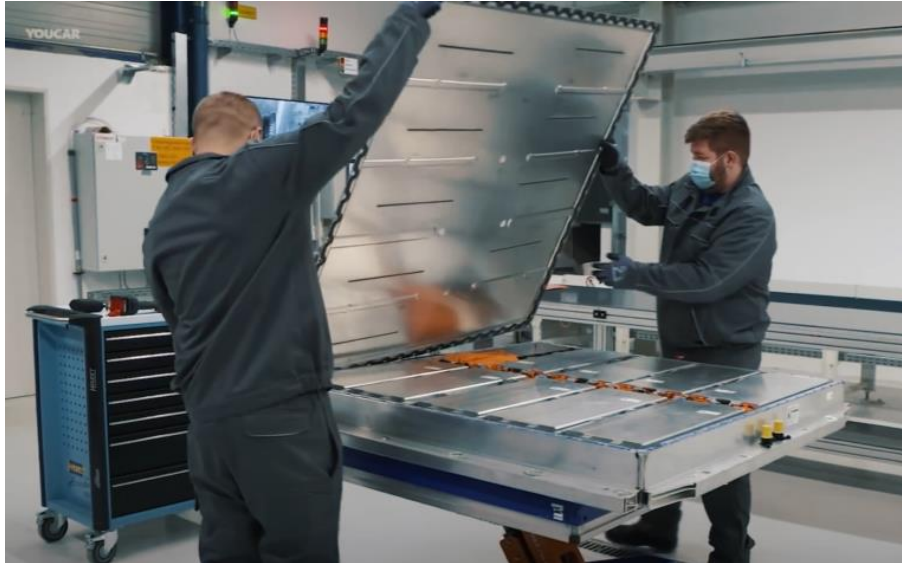
Ouverture d'un pack de batterie de VE, les modules contenant les cellules sont visibles
