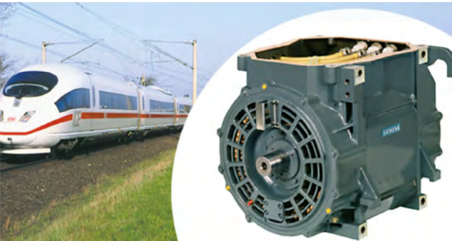
Moteurs de traction des locomotives à grande vitesse (besoin de vitesse et de rendement)
